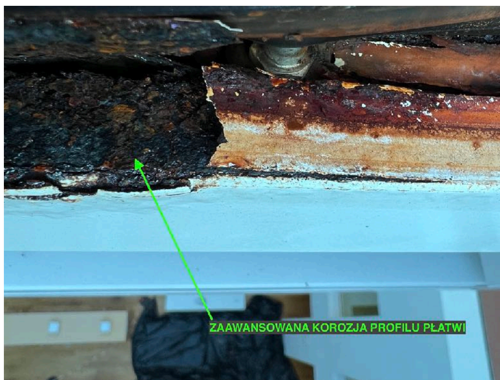
9. Pod uszkodzoną powłoką lakierniczą w rowku okuciowym i na płóce - zaawansowana korozja.
